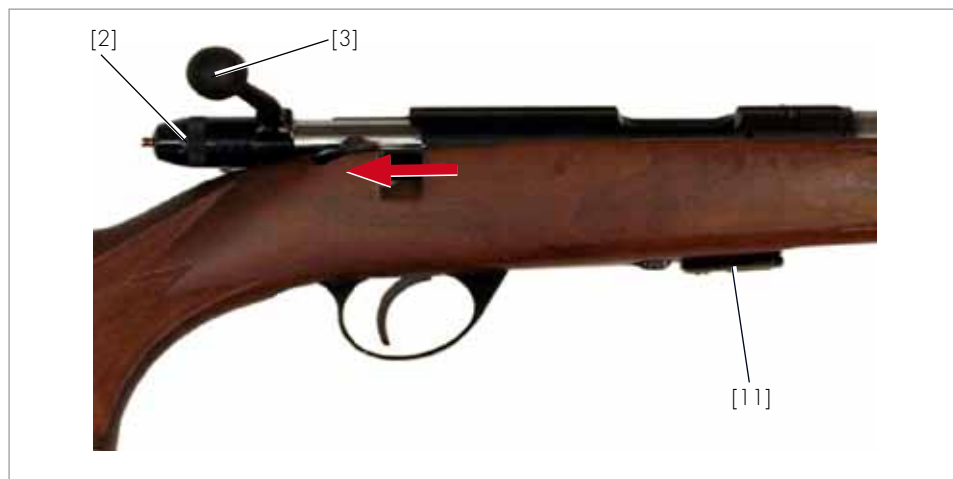
Fig. 6 Ouverture de la culasse
