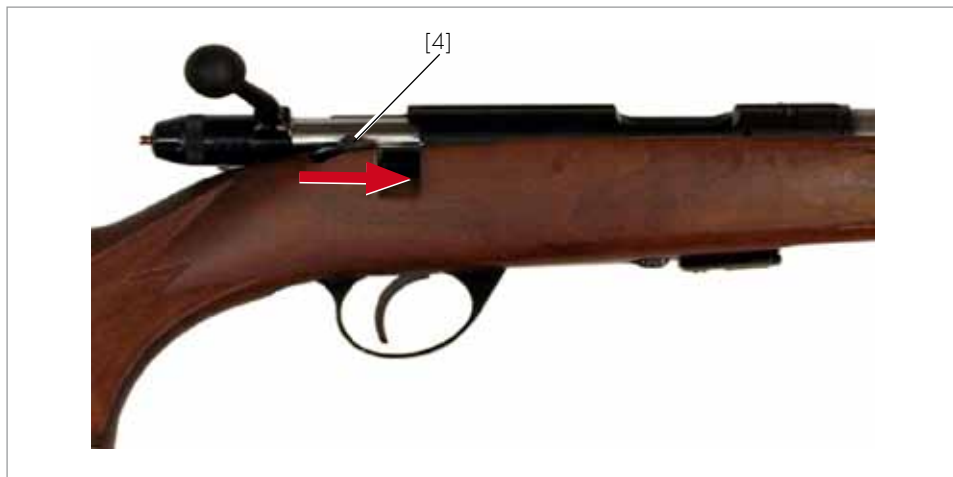
Fig. 10 Déplacement du levier de sécurité vers l'avant (déverrouillage)
