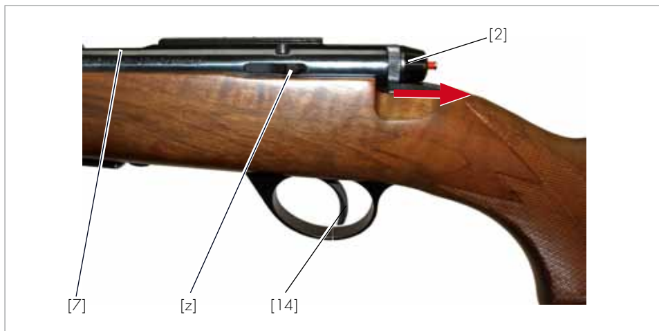
Fig. 16 Extraction de la culasse
