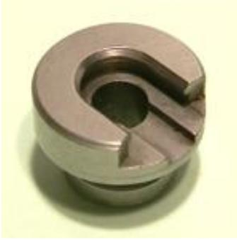
C'est la pièce qui maintient l'étui sur le béliet de la presse, elle peut être utilisée pour différents étuis compatibles et donc couvrir différents calibres.
