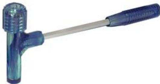
La cartouche est insérée dans une pince, laquelle est montée dans un réceptacle (généralement en plastique). On utilise cet outil comme on le ferait d'un marteau en tapant fort sur une surface dure. Par inertie, le projectile va petit à petit sortir de l'étui jusqu'à le quitter et se retrouver au fond du réceptacle.
