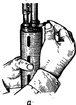
Рис. 10. Отделение ствольных накладок:
